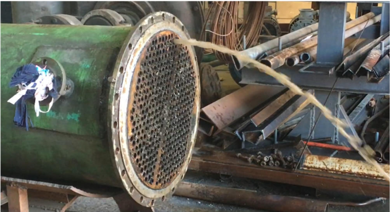
Мал. 5. Видалення відкладень кальцію/мулу струмом води після роботи приладу HF.
