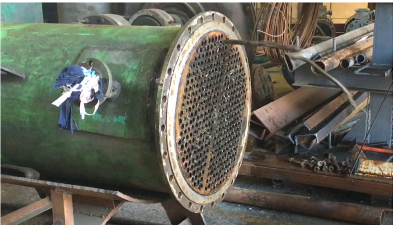
Мал. 4. Видалення відкладень кальцію/мулу струмом води після роботи приладу HF.
