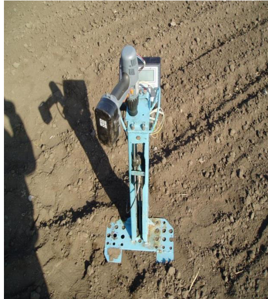
Рис. 4. Визначення твердості ґрунту за допомогою твердоміру
