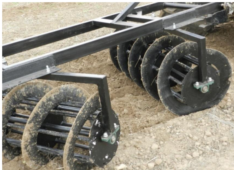
Рис. 2. Загальний вигляд експериментального взірця борони з гвинтовими робочими органами
