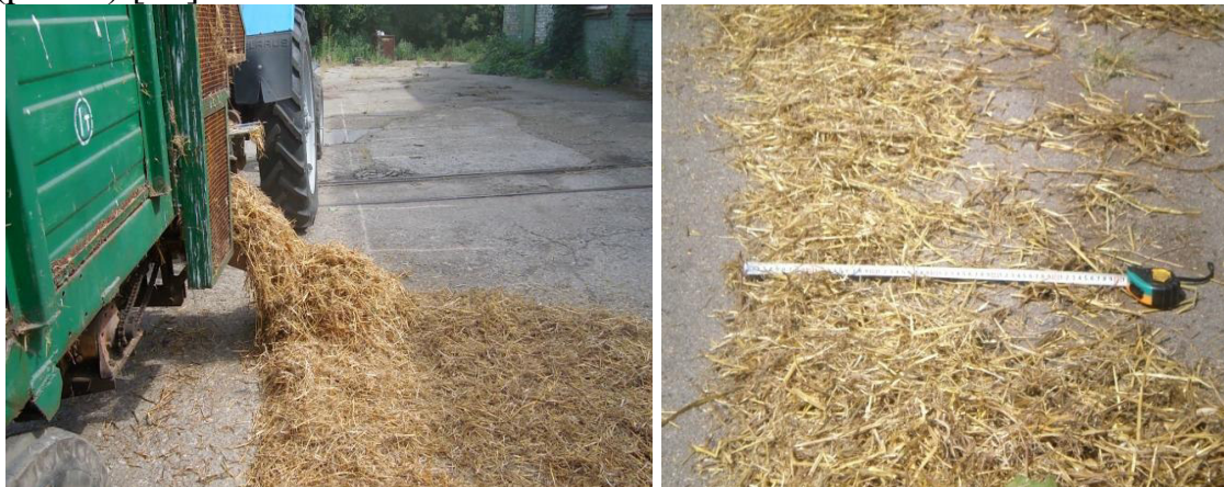
Рис. 3. Визначення довжини шляху, що пройшов мобільний розкидач солом'яної підстилки та ширини смуги розкидання
