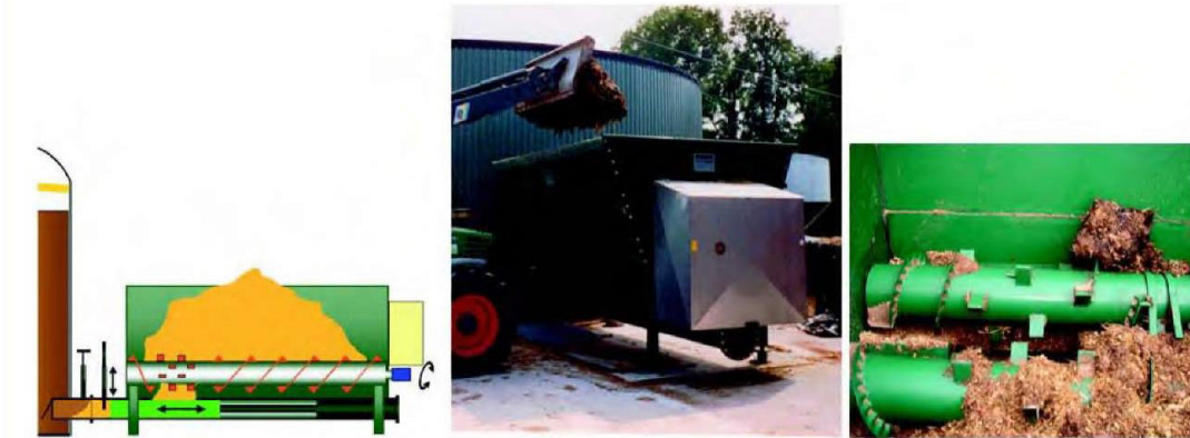
Рис. 6. Гідравлічні системи завантаження спеціальним поршнем фірми «PlanEt»
