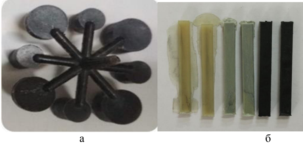
Рис. 2. Зразки для експериментальних досліджень: а) Границі текучості матеріалу; б) Ударної в'язкості
