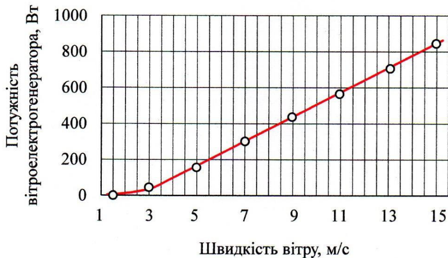
Рис. 5. Залежність потужності ВЕГ від швидкості вітру при струмі навантаження 25 А
