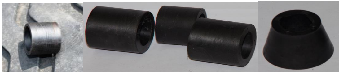
Рис. 7. Експериментальні деталі, виготовлені з ПКМ УПА-6-30, з додаванням 5 % ВП LDPE
