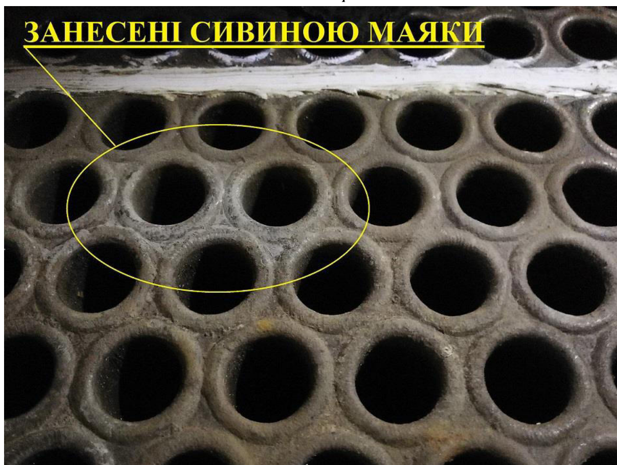
Мал.36 Занесені "сивиною" маяки на трубній дошці ОБ'ЄКТУ"+
