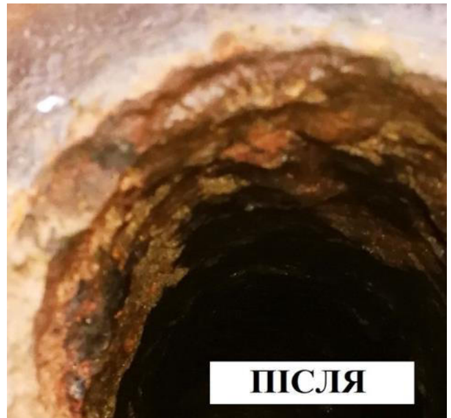
Мал.19 Елемент «В», крихка структура відкладень з частково вимитими кальцитами, вм'ятини частково розкрито та зруйновано
