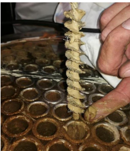
Мал.51 Відбір проб відкладень з внутрішньої поверхні ТОТ ОБ'ЄКТУ«0»
