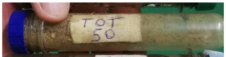
Мал.52 Контейнер зі зразком проб відкладень з внутрішньої поверхні ТОТ ОБ'ЄКТУ«0»
