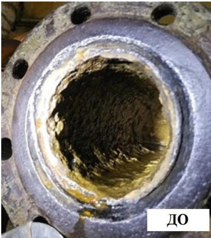
Мал.10 Очищення внутрішньої поверхні труби відводу техводи ОБ'ЄКТУ"«+» від відкладень металевим шпателем під час проміжного розкриття . У позиції «на 9 годин» шпателем, без особливих зусиль, зроблено додатковий маяк
