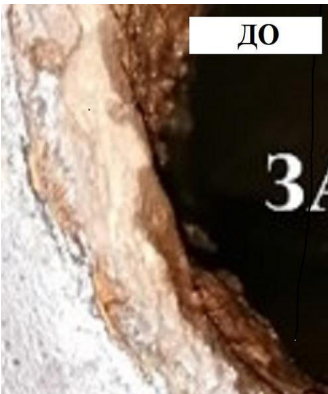
Мал.20 Елемент «Г», тверда скловидна «залізана» карбонатна структура відкладень
