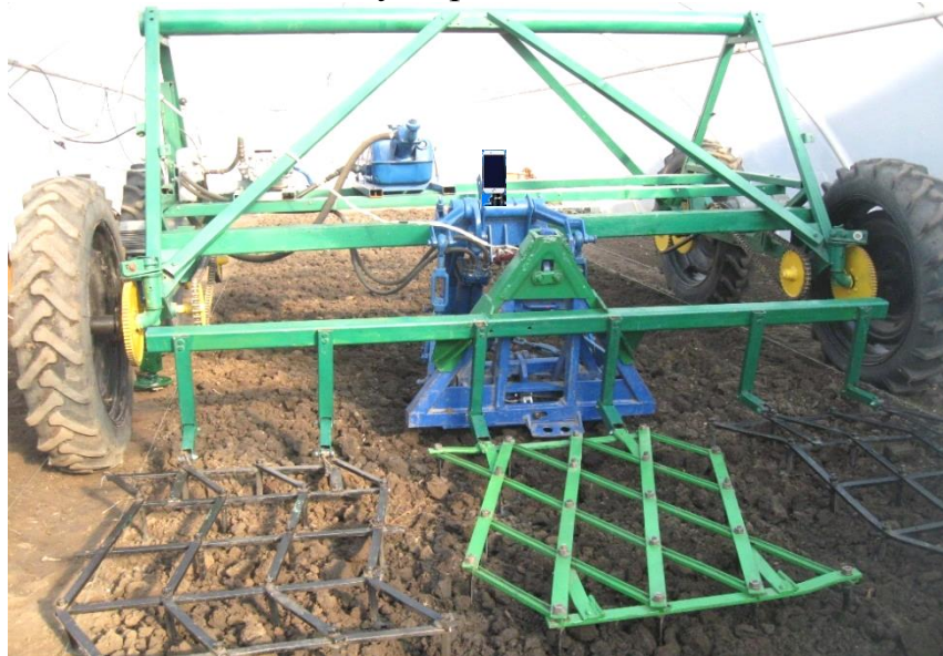
Рис. 1. Спеціалізований ширококолісний агрозасіб ТДАТУ в складі боронувального агрегату під час проведення досліджень
