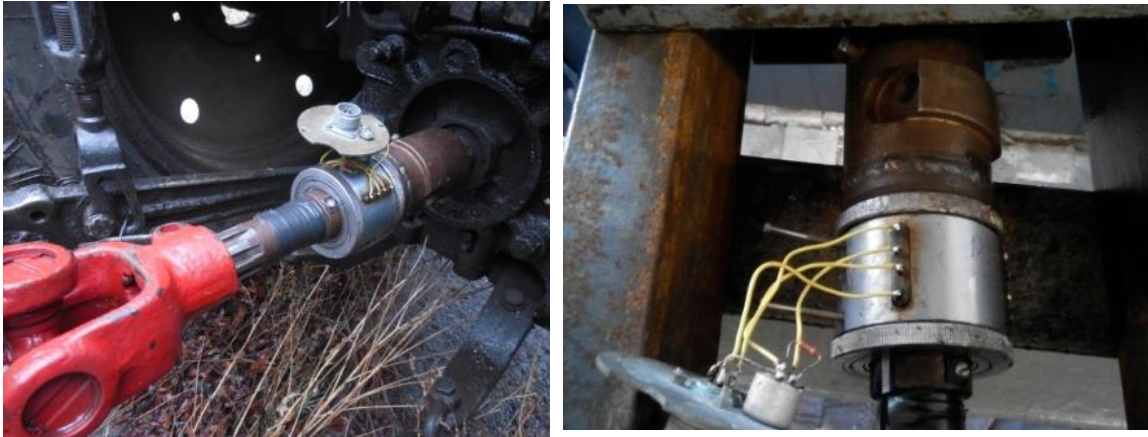
Рис. 4. Визначення крутного моменту на валу відбору потужності трактора
