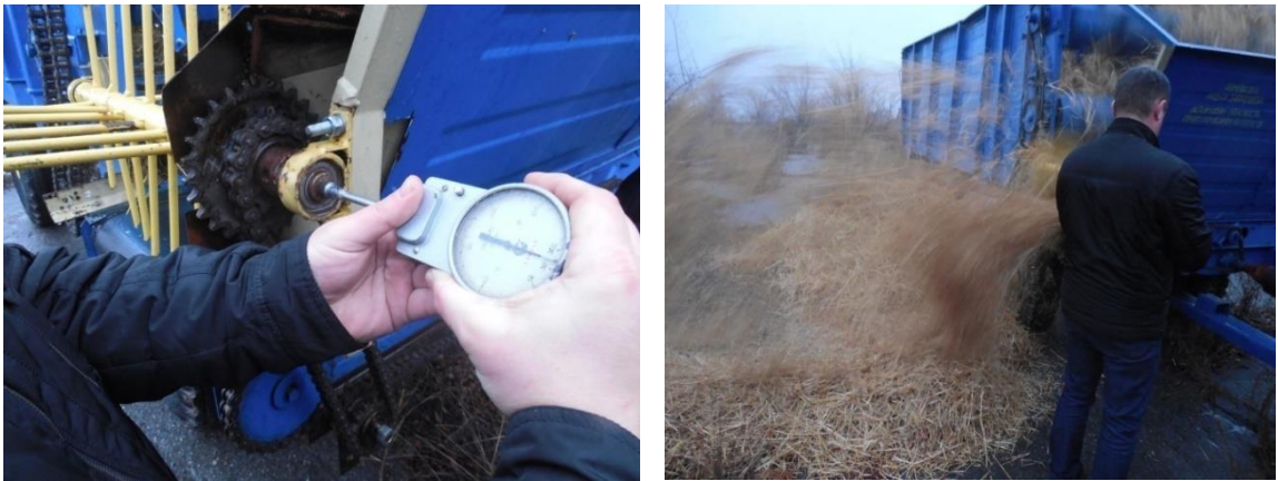
Рис. 5. Визначення частоти обертання валу робочого органа розкидача та валу відбору потужності трактора
