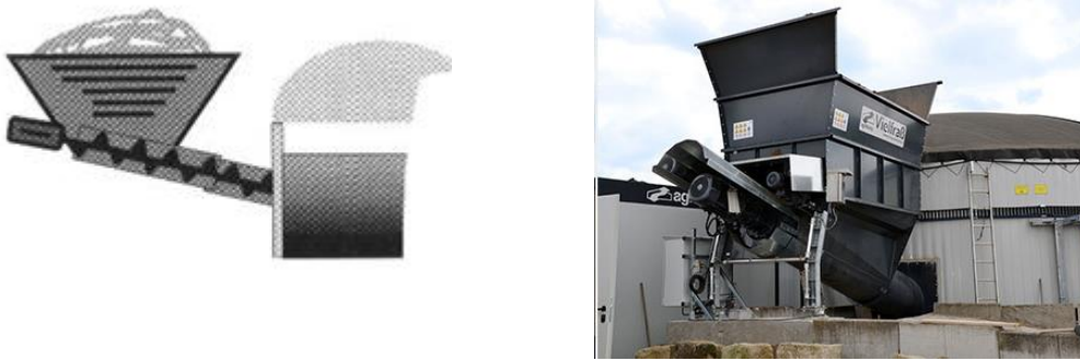
Рис. 3. Шнековий транспортер з накопичувальним бункером фірми «AgriKomp»
