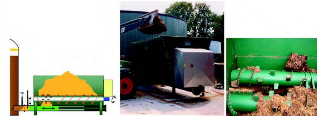
Рис. 6. Гідравлічні системи завантаження спеціальним поршнем фірми «PlanEt»
