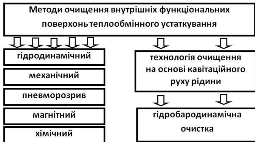
Рис. 1. Основні методи очищення внутрішніх функціональних поверхонь теплообмінного устаткування
