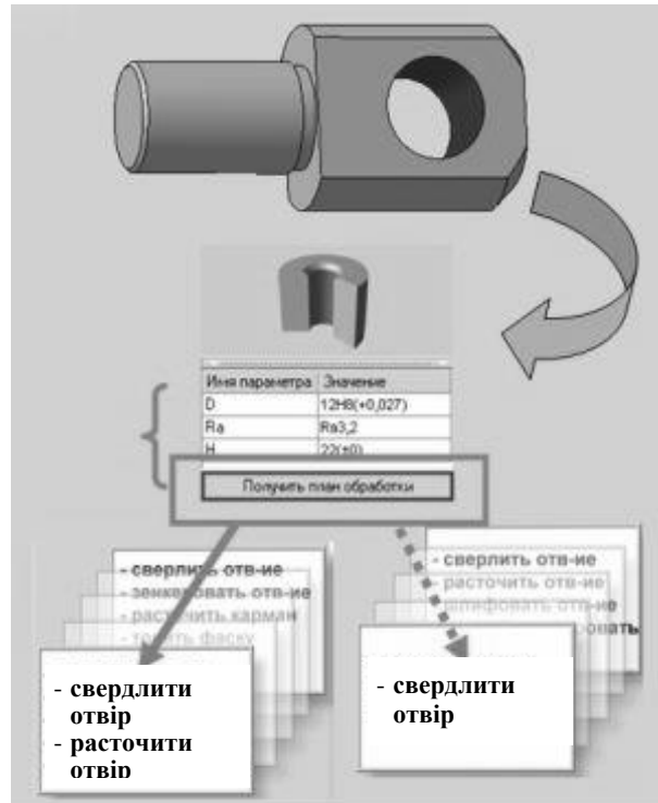
Рис.2. Схема формування плану обробки КТЕ
