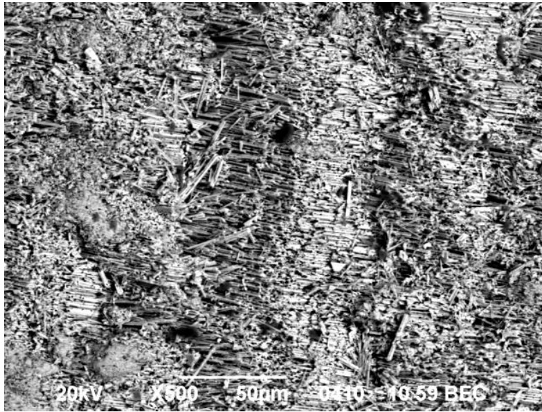
Рис. 1. Морфології поверхні Si пластин після електрохімічного травлення ( j \sim 100 \text{ mA/cm}^2 , T=300\text{K} , 45% HF, 40% HCl, \text{H}_2\text{O} та 96% \text{C}_2\text{H}_5\text{OH} 1:1:1:1, t=10\text{хв} )
