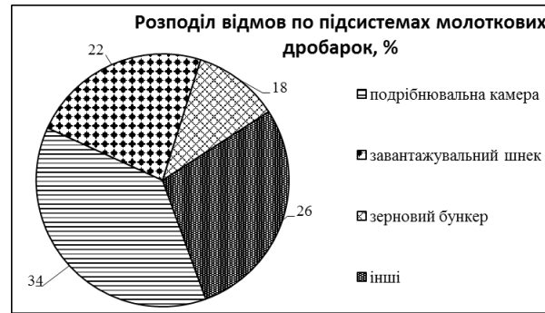
Рис. 1. Розподіл відмов по підсистемах молоткових дробарок, %
