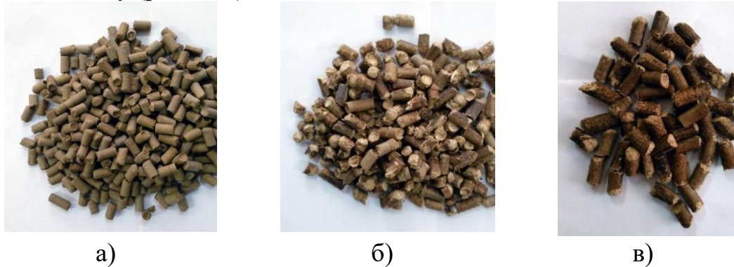
Рис. 5. Отримані експериментальним шляхом гранули з очерету: а) 1-10 хв. роботи гранулятора б) 11-20 хв. роботи гранулятора в) 21-30 хв. роботи гранулятора
