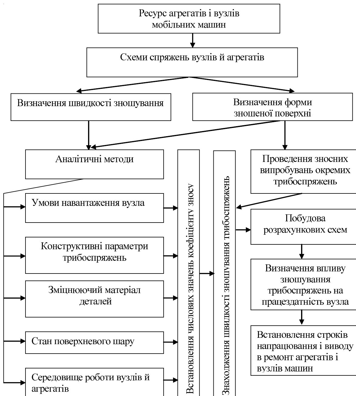
Рисунок – Структурна схема прогнозування ресурсу деталей агрегатів і вузлів машин до виводу їх в ремонт
