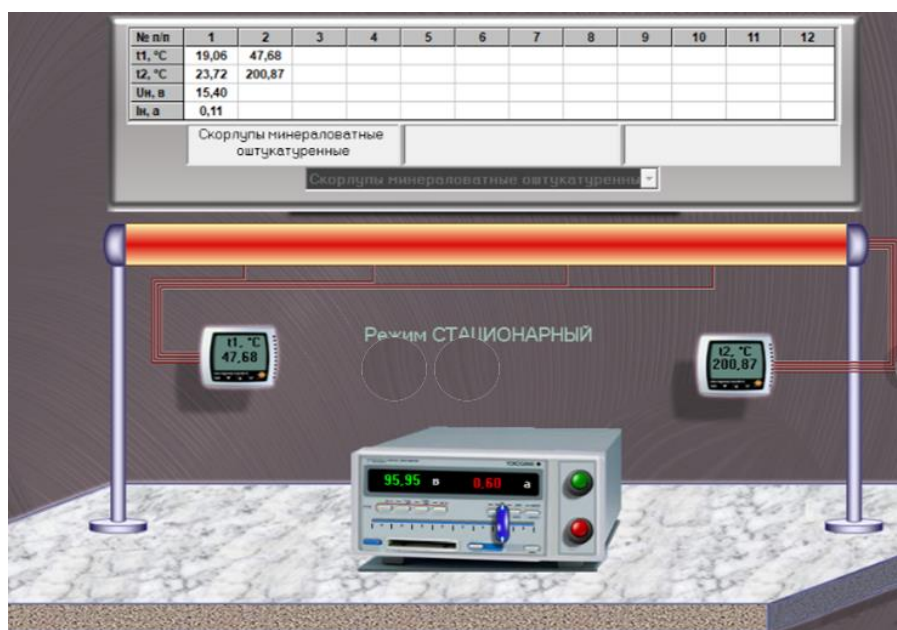
Рис. 4. Установка до лабораторної роботи «Випробування теплообмінного апарату типу «труба в трубі».
