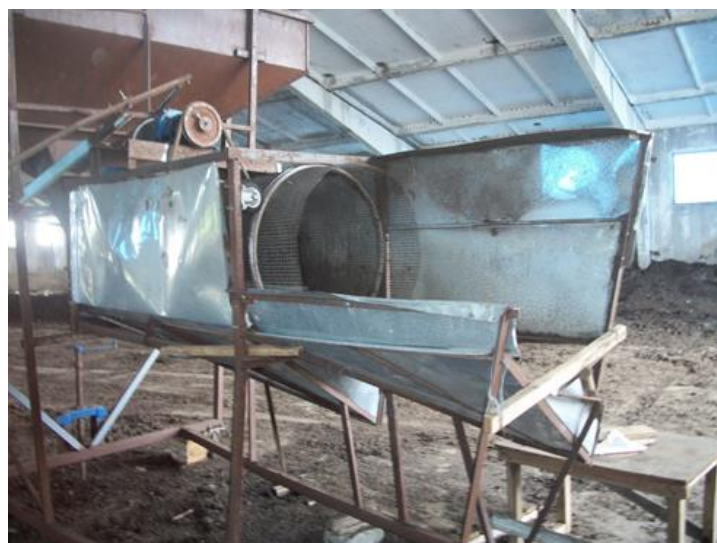
Рис. 1. Конструкція установки для сепарації компостної суміші (варіант)
